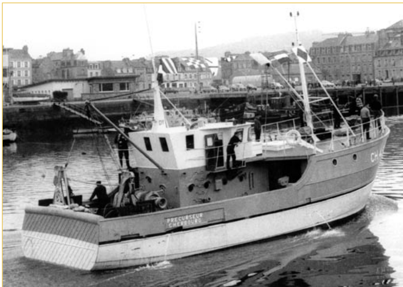
Avec le « Précurseur » Yvon David innove : le bateau est équipé d'un pont couvert où l'équipage travaille à l'abri.
